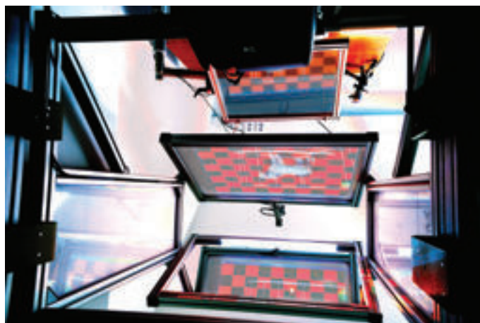
FOTO Zařízení Spinnstube. Ze dvou nad sebou umístěných projektorů jsou promítány dva lineárně polarizované obrazy, které se pozorovatel pomocí levných polarizačních brýlí skládají do jediného kvalitního obrazu evokujícího třírozměrný vjem
